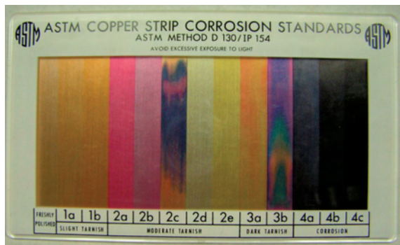
Imagen 2. Escala de Color para la clasificación del Azufre Corrosivo ASTM D1275.
